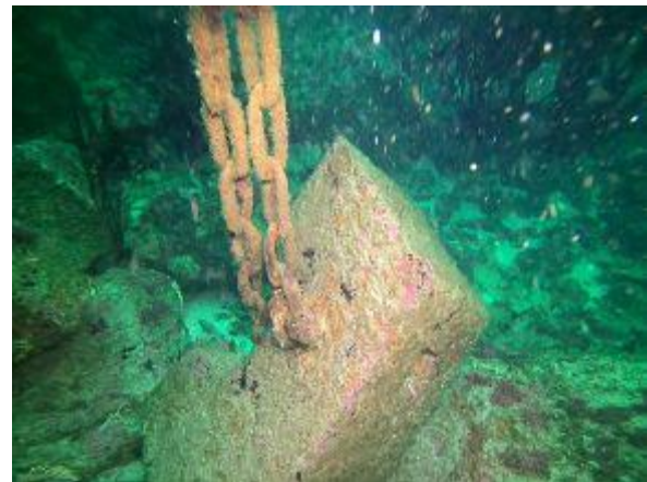
Abrazadera conectada por cadena a lastre en el fondo a los 1.290 metros sin observaciones
